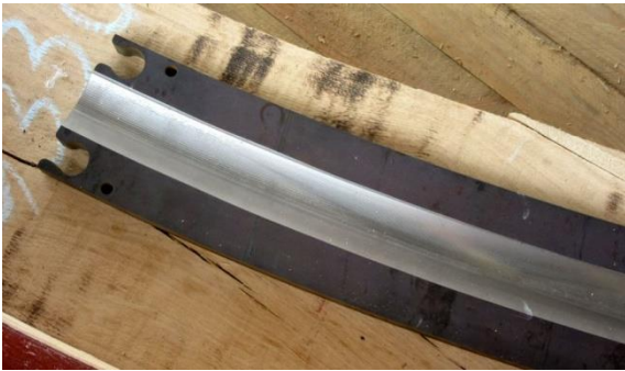
Aus solchen 20 mm starken Segmenten wird die untere Laufbahn zusammengesetzt. In der Kehle werden später die 30 Kugeln laufen, welche die Kappe tragen. (Foto: H. Hinze)
