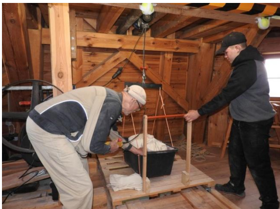
Der Rollwagen zum Absetzen der Wanne mit den beiden Säcken hat sich bewährt. Er erhöht die Sicherheit, denn man muss sich beim Entladen der Wanne nicht mehr über die offene Falltür beugen. Der Wagen wird zurückgezogen, die Säcke mit dem Mahlgut werden entnommen und dann in den Trichter geschüttet.
